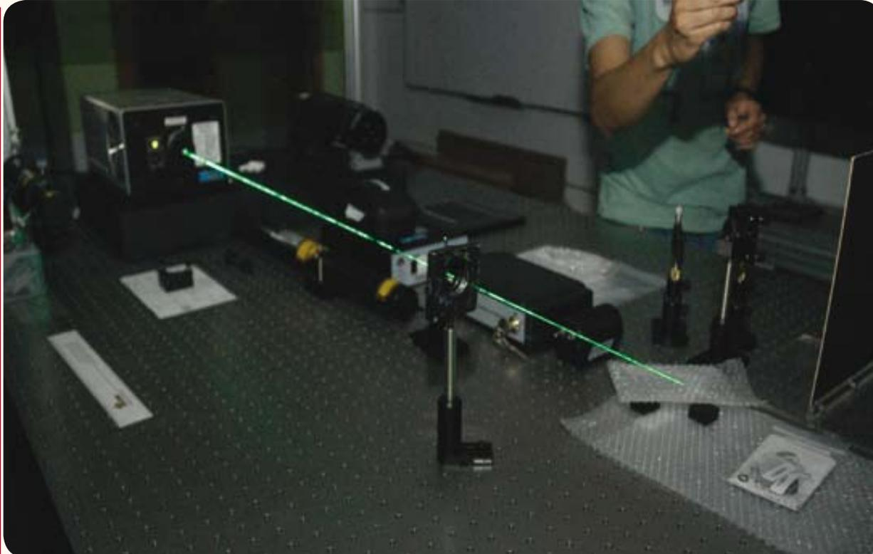
Imagen del esparcimiento del haz láser desde su salida del dispositivo láser, donde se observa el haz concentrado, lo que comúnmente se le llama "rayo láser", pero este término está mal empleado (foto Jorge Carvajal).
