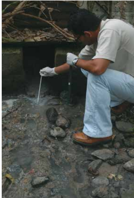
Para determinar el estado del arsénico en el agua se emplea una cápsula conectada a una jeringa que extrae el agua, y un filtro desechable para atrapar el arsénico +V (foto ilustrativa archivo ODI).
