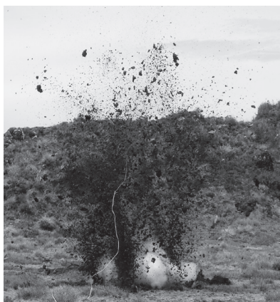
Como parte de las actividades del proyecto, se realizaron experimentos de sismica de reflexión, que consisten en inducir ondas sísmicas al subsuelo, con el fin de generar un modelo de la estructura geológica (foto Carlos Redondo Ch., RSN).
