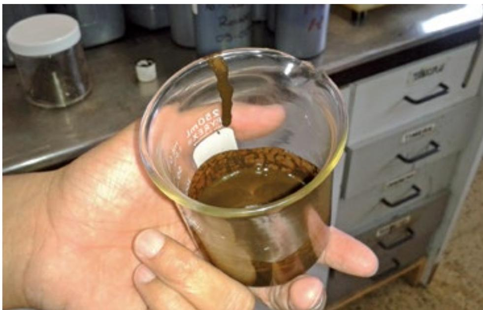
Emulsión de asfalto a temperatura ambiente (foto cortesía Lanamme).
