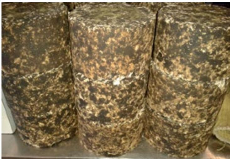
Compactación de la emulsión con el material que se utiliza en las bases de carreteras de lastre (foto cortesía Lanamme).
