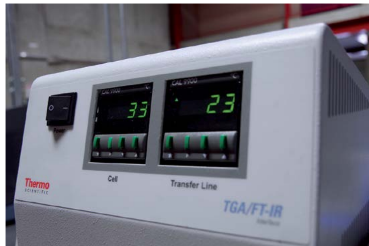
Equipo Espectrómetro Infrarrojo (FTIR) se utiliza para analizar compuestos de materiales utilizados como modificantes (foto cortesía LanammeUCR).
