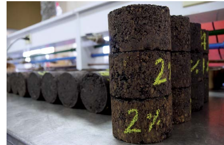
Se utilizan ciertos materiales que se trabajan a bajas temperaturas con lo que se logran reducir las emisiones de gases contaminantes. (foto cortesía LanammeUCR).
