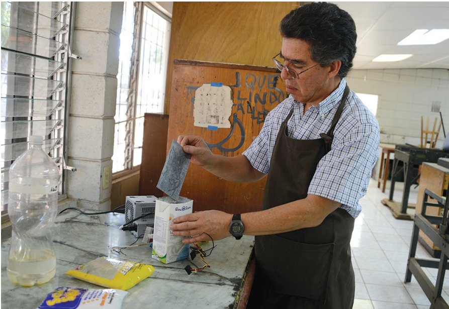
El Dr. Francisco Hernández Chavarría introduce la lámina dibujada en la caja reciclable. Junto a él la cera líquida, la sal y la botella de agua con sal utilizada en el proceso de electrólisis (foto Laura Rodríguez).
