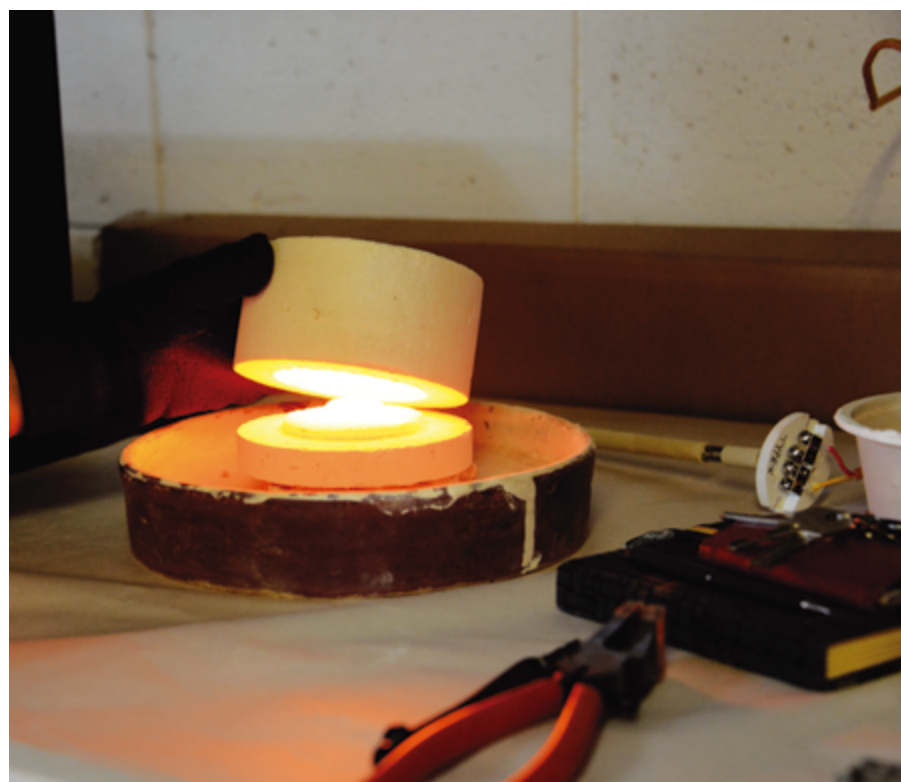
Este horno que funciona con microondas se utiliza para hacer piezas de pequeño tamaño (foto Anel Kenjekeeva).
