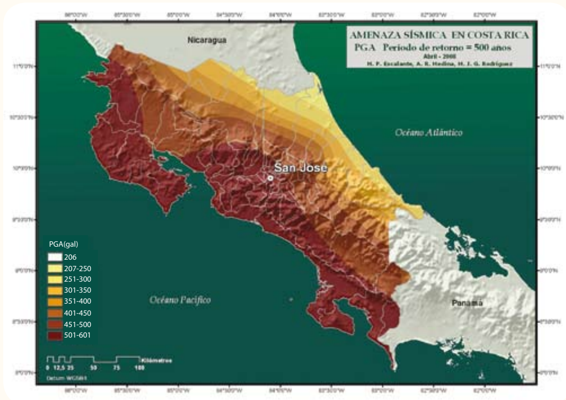
Mapa de aceleraciones máximas estimadas para Costa Rica para un período de retorno de 500 años. En gran parte del país, desde Guanacaste hasta la zona sur, se pueden generar aceleraciones muy fuertes de más de 500 gals (porcentaje de la gravedad), (proyecto RESIS II, 2008).
