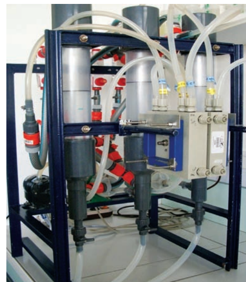
Este es el módulo de electrodiálisis, equipo que se utiliza en la etapa final de purificación y concentración de la solución del ácido láctico (foto cortesía CITA)
