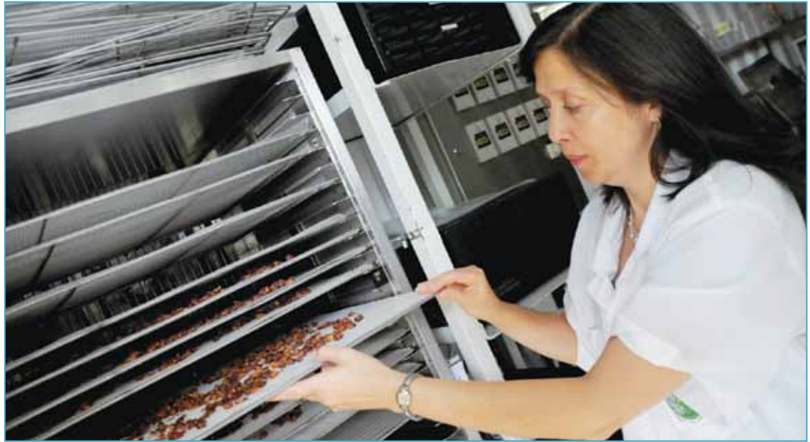
La Dra. Elba Cubero, investigadora del CITA, explicó que como parte del proceso tecnológico, la pulpa del café es sometida a un secado a vapor para conservar las propiedades antioxidantes (foto Anel Kenjekeeva).
