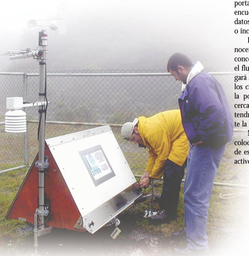
Los investigadores Carlos Ramírez y Raúl Mora, en la estación geoquímica ubicada en el Poás, que registra continuamente el flujo de dióxido de carbono y el sulfuro de hidrógeno en el área volcánica.
