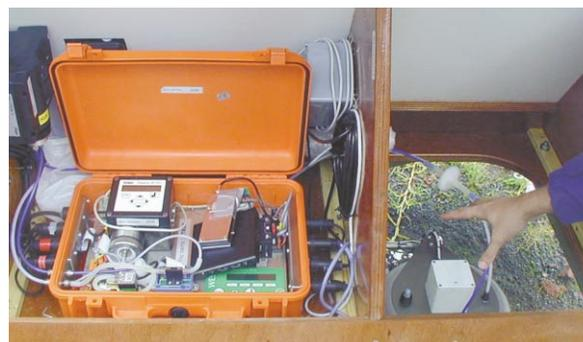
La estación geoquímica tiene una cámara de gas que cada hora desciende automáticamente y se posiciona sobre la superficie del suelo, para hacer la medición de gas que emana del subsuelo.
