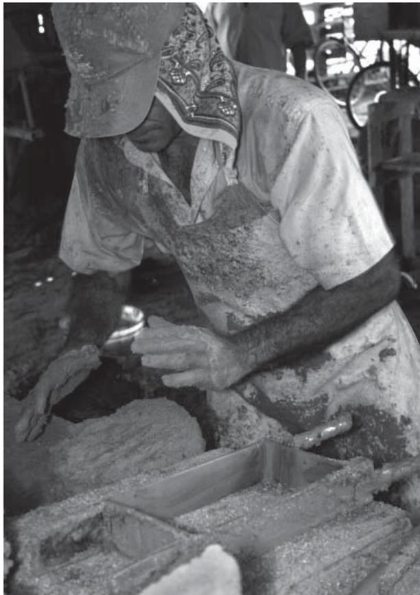
Manuel Castro, en la ladrillera artesanal La Chacona, da forma a los ladrillos en moldes de metal.
