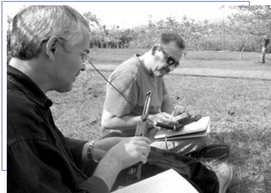
Los estudiantes de la Maestría utilizando el psicómetro, instrumento para medir la temperatura ambiental y la humedad relativa. (Foto: Grettel Rojas Vásquez)
