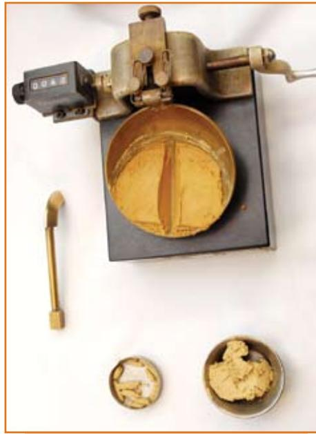
En el Laboratorio de Geotecnia, donde se realizan estudios de los suelos y las rocas desde el punto de vista físico y mecánico, se mide la plasticidad del suelo.
