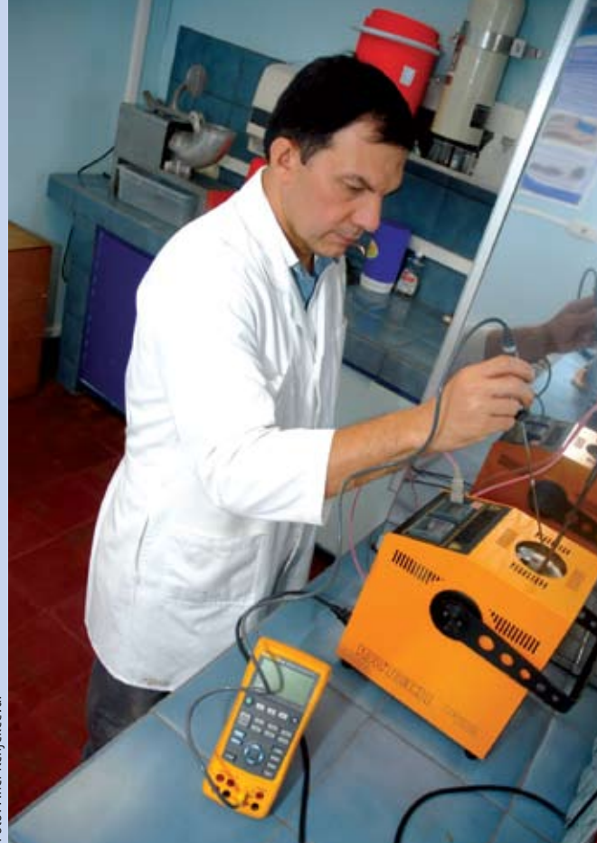
Uno de los servicios que más solicitan a LABCAL es la calibración de termómetros de líquido en vidrio.
