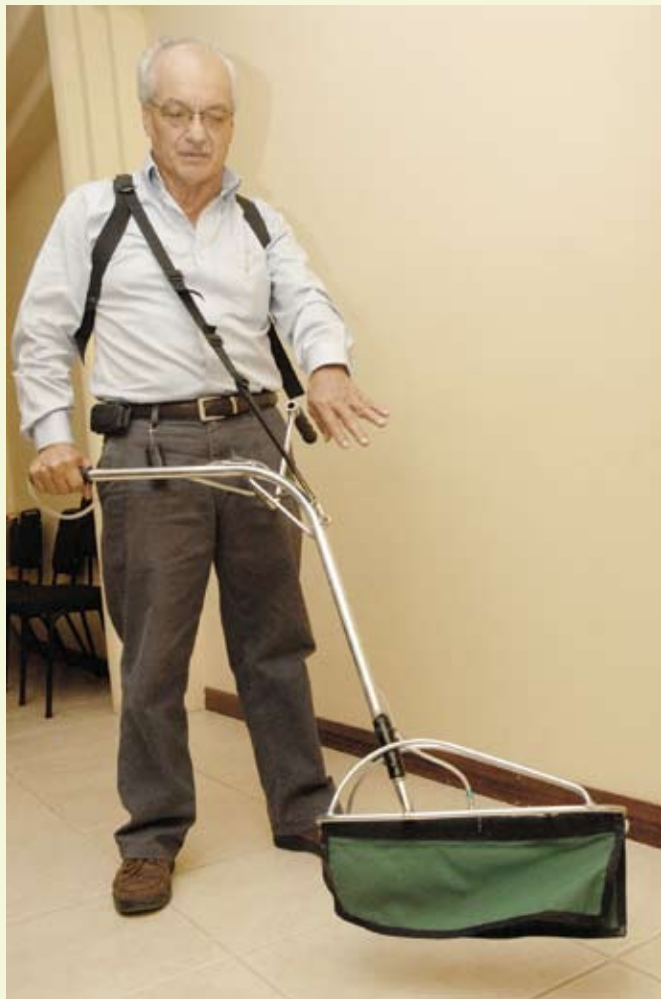
Foto: archivo ODI. El Primo Ecoweeder es un aplicador manual de insecticidas creado por el Dr. Primo Luis Chavarría, Premio Nacional de Tecnología 2008, incluido entre las cinco invenciones que la UCR intenta patentar (foto: archivo ODI).
