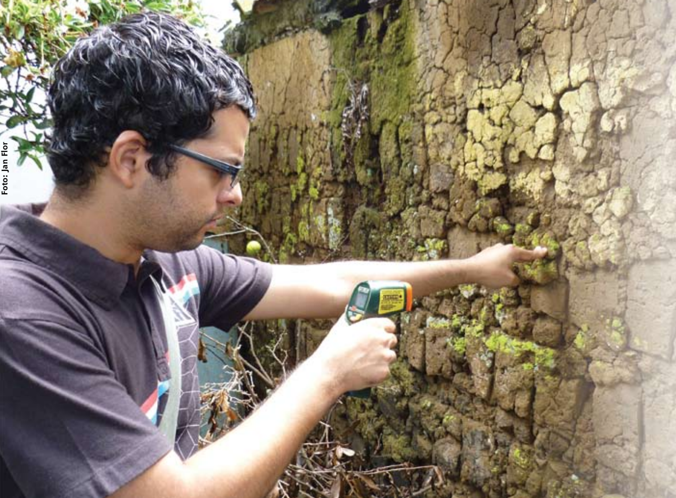
El estudiante Moisés Obando mide con un termómetro infrarrojo la temperatura superficial de una tapia de adobe en Santo Domingo de Heredia.
