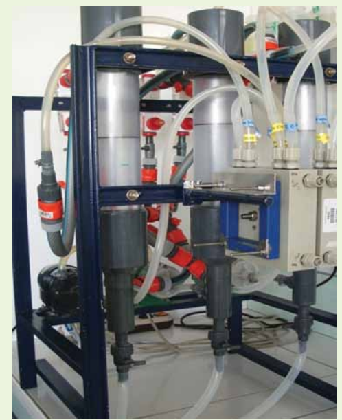
Este es el módulo de electrodiálisis, equipo que se utiliza en el CITA para la etapa final de purificación y concentración de la solución del ácido láctico (foto cortesía CITA)
