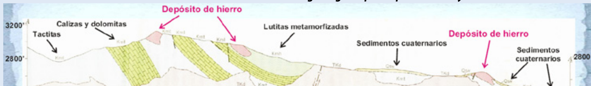
Perfil geológico del famoso yacimiento de hierro de Agalteca, Honduras, explotado desde el siglo XVI. Reformado del trabajo de Roberts & Irving de 1957, sobre los yacimientos minerales en América Central.
